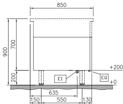
EI = Conexión eléctrica (energía)
